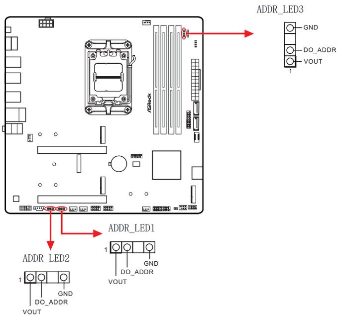
将可寻址 RGB LED 灯条连接到主板上的可寻址 LED 接脚 (ADDR\_LED1 / ADDR\_LED2 / ADDR\_LED3)。
