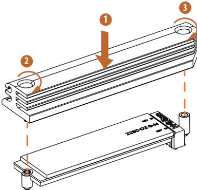
按图示顺序用螺丝刀拧紧螺丝，将模块（如果 M.2 SSD 模块为 2280 型）和 M.2 散热器固定到位。先拧紧 M.2 接口对侧的螺丝（2），然后再拧紧 M.2 接口旁边的螺丝（3）。\* 请勿过分拧紧螺丝，否则可能会损坏模块和 M.2 散热器。
