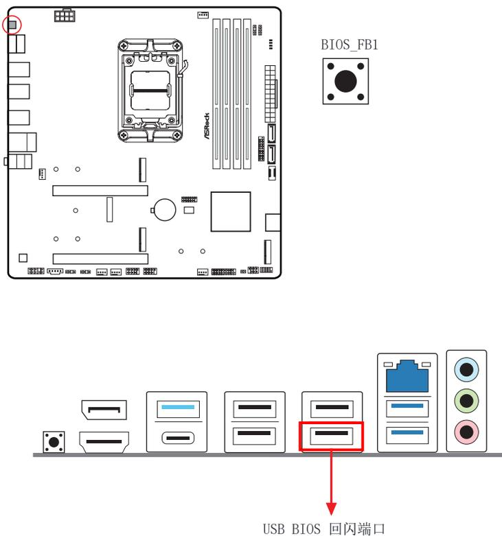
借助 ASRock BIOS 回闪功能，无需为系统通电、甚至无需使用 CPU 即可更新 BIOS。
